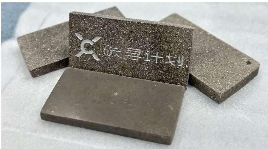
北京科技大学将废弃钢渣和二氧化碳结合变成砖头，项目入选首期“碳寻计划”终选名单
