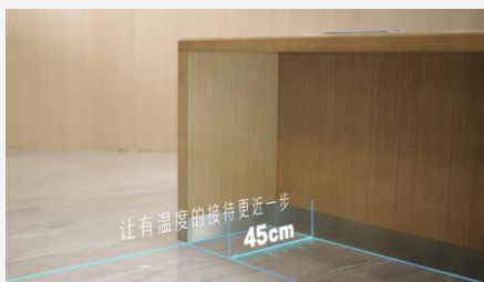
在柜台，将留足大于 45cm 的容膝深度，让双脚有处安放
